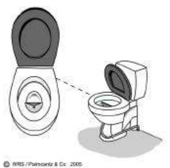
Figur 2. Det finns olika typer av urinsorterande toaletter, från de enklaste torrtoaletterna till mer moderna toaletter i porslin. En urinsorterande vattentoalett har två utlopp. Bakre delen, där fekalier och papper hamnar, spolås som en vanlig vattentoalett. Främre delen spolås oftast också, fast med liten mängd vatten. (Illustration: Johan Palmcrantz).
