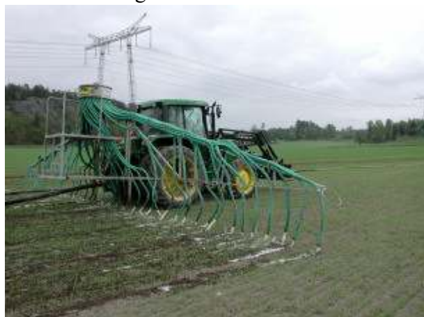
Figur 28. Spridning av urin med matarslang och släpslangsspridare i Bornsjöområdet. (Foto: Ebba af Petersens)
