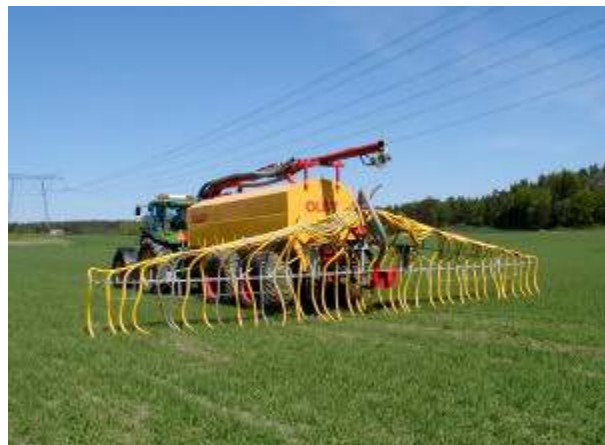
Figur 28. Spridning av urin med matarslang och släpslangsspridare i Bornsjöområdet. (Foto: Ebba af Petersens)
