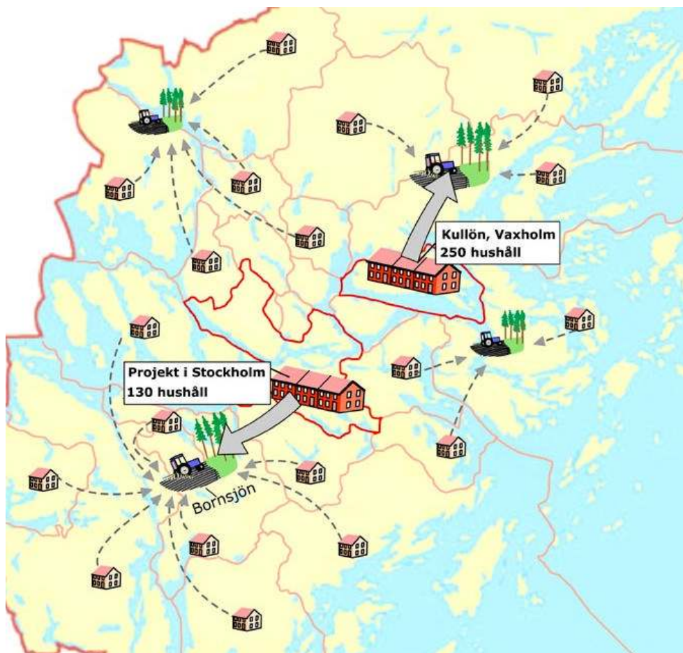
Figur 31. Stockholms län finns idag ett större system för återföring av humanurin i drift vid Bornsjön i Salems kommun och ytterligare ett är på gång att etableras för urin från området Kullön i Vaxholm. Båda dessa utgör möjligheter för andra kommuner att transportera urin från enskilda fastigheter till dessa för lagring och spridning (vilket symboliseras av de streckade pilarna i figuren) 31 . (Illustration: Johan Palmcrantz.)
