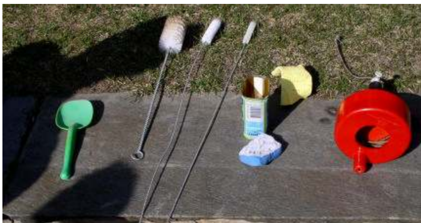
Figur 14. En rensvajer eller olika typer av flaskborstar kan användas för att rensa bort eventuella stopp i urinvattenlåset. Bilden visar de rengöringsdon som de boende i Gebers använder. (Foto: Verna Ekologi AB.)
